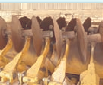
Le Disc-O-Mulch, déchaumeur à disques.
